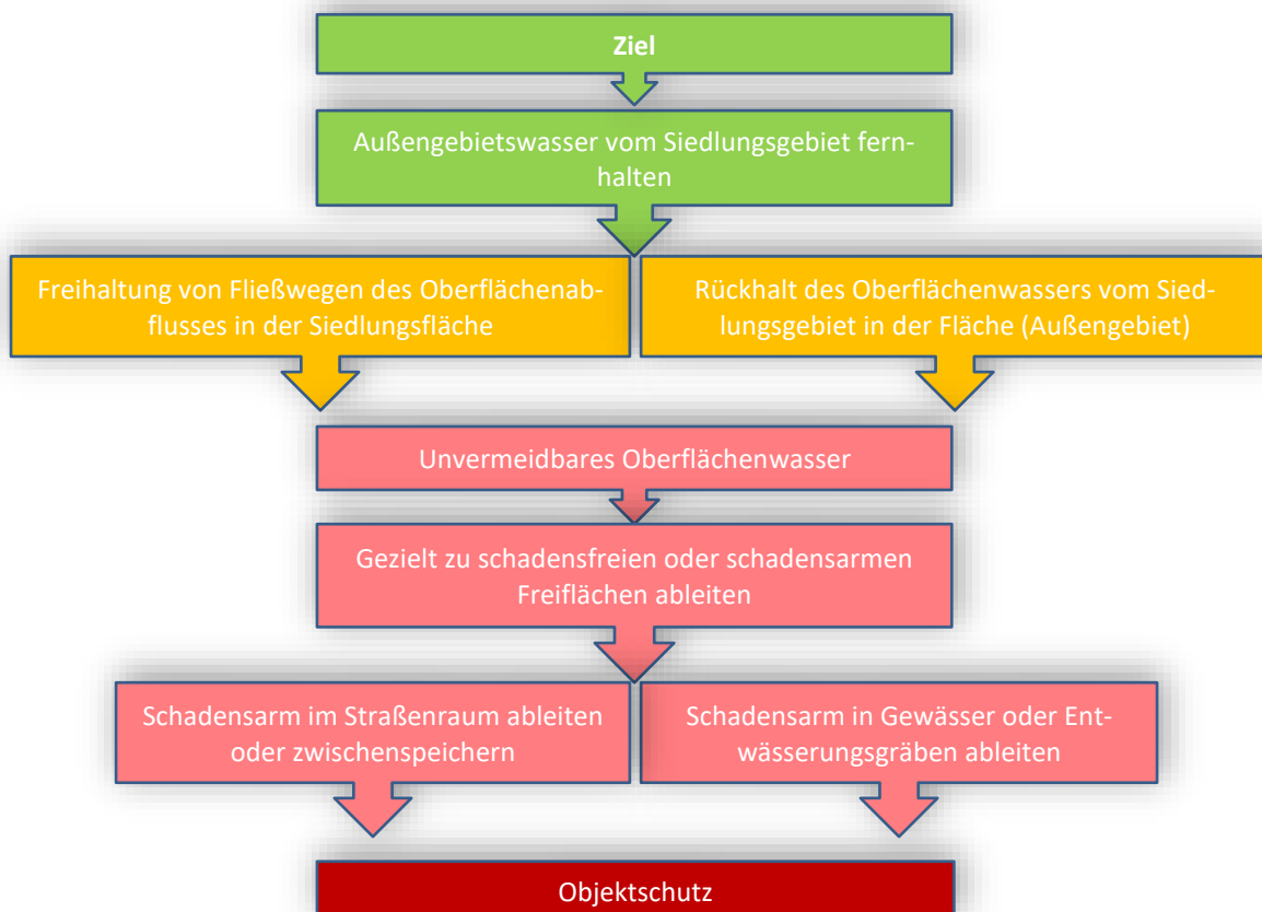
Abbildung 7: Struktur/prinzipielle Vorgehensweise in der Konzeption kommunaler baulicher Maßnahmen (frei nach Leitfaden SRRM, LUBW)
