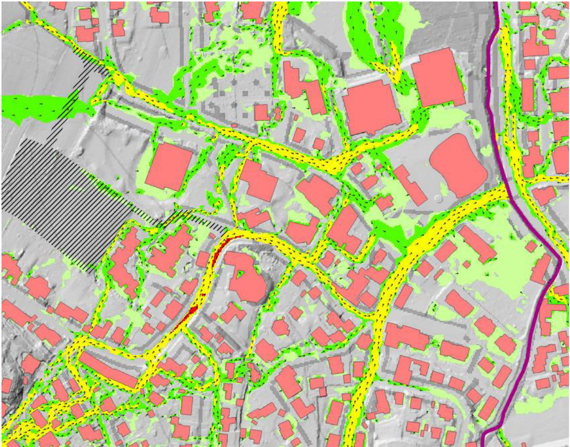
Abbildung 20: Strömungsverhältnisse im Bereich der Ortsmitte Merzhausen
