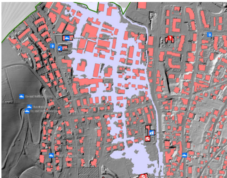
Abbildung 9: Hochwasser-Betroffenheit (HQ 100 ) in Merzhausen
