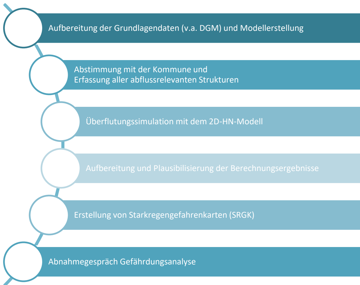
Abbildung 2: Ablauf der hydraulischen Gefährdungsanalyse
